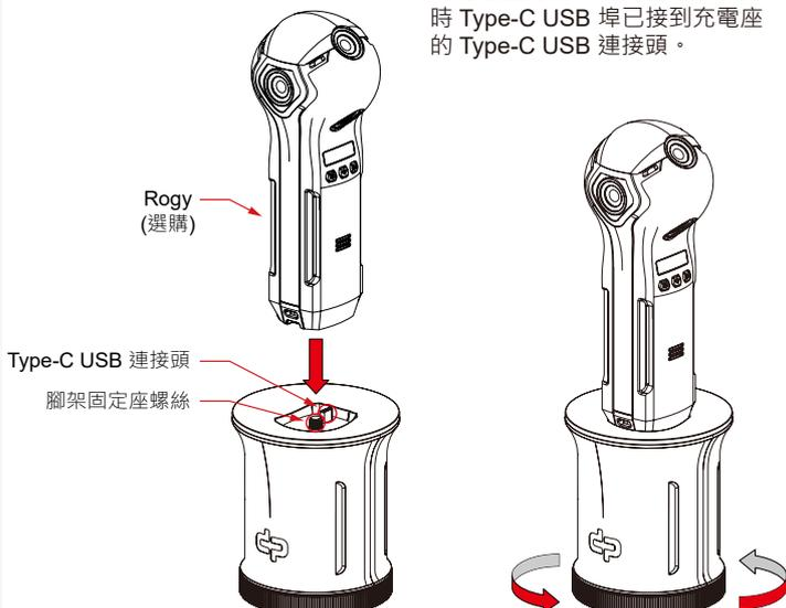
2. 輕壓 Rogy 在充電座上，然後順時鐘旋轉腳架固定座轉盤，將 Rogy 鎖緊。
