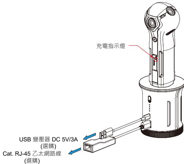
5. 將 USB 傳輸線的 Type-A 接頭插到 DC 5V / 3A 變壓器的 USB 埠。
